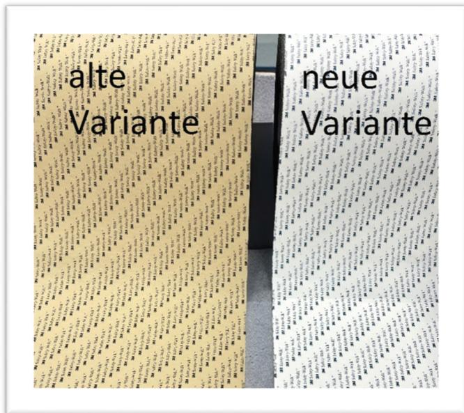
3M Controltac™ ist eine geschützte 3M Technologie, die es ermöglicht, das Traktionsmaterial vor der endgültigen Verklebung auf der Oberfläche neu zu positionieren. Dieses neue Trägermaterial verfügt außerdem über die geschützte 3M Comply™ Technologie, die Luftablasskanäle bietet, um eine blasenfreie Anwendung zu ermöglichen.
